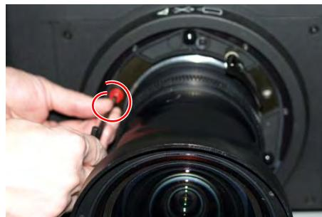
7. С помощью шестигранника на 5 мм затяните красные фиксирующие винты узла крепления объектива либо руками затяните фиксирующие винты объектива. Рекомендуется для наиболее тяжелых объективов, таких как 0,73:1 и 1,2:1.
